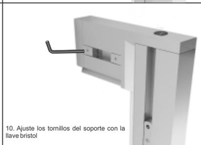
10. Ajuste los tornillos del soporte con la llave bristol
