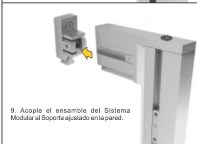
9. Acople el ensamble del Sistema Modular al Soporte ajustado en la pared.
