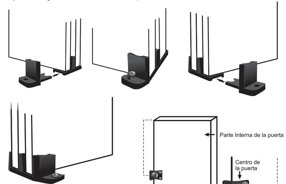
b) Ubique el centro en el borde de la parte interna de la puerta y ajuste el freno como se muestra en la ilustración
