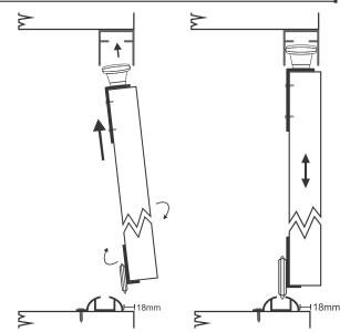
a) Luego de realizar la instalación de las puertas se deben ajustar los tornillos superiores de las rodachinas; los cuales permiten regular la altura de las hojas.
