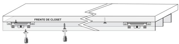
b) Graduar los tornillos de la guía con la llave bristol, con el fin de ajustar la altura del botón de enganche, para activar el cierre lento.
